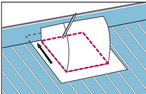
Glissez la partie du haut de la base en-dessous du recouvrement du faîte de toit. Tracer à l'aide d'une craie l'intérieur du solin, en s'assurant d'avoir le solin parallèle au faîte du toit. La première ailette à partir du bas de la base doit dépasser d'au moins 15 cm (6") le faîte du toit.
