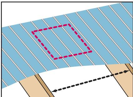
Déterminez la position de l'unité. Localisez dans l'entretoit où sont situés les fermes de toit (truss) et positionnez entre les fermes de toit.
