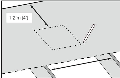
Déterminer l'emplacement du ventilateur au centre de deux fermes de toit et à 122 cm (4 pieds) du parapet de toit. Tracer à l'aide d'une craie un carré de 30,5 x 30,5 cm (12 x 12 pouces), en s'assurant qu'il soit parallèle au bord du toit.
