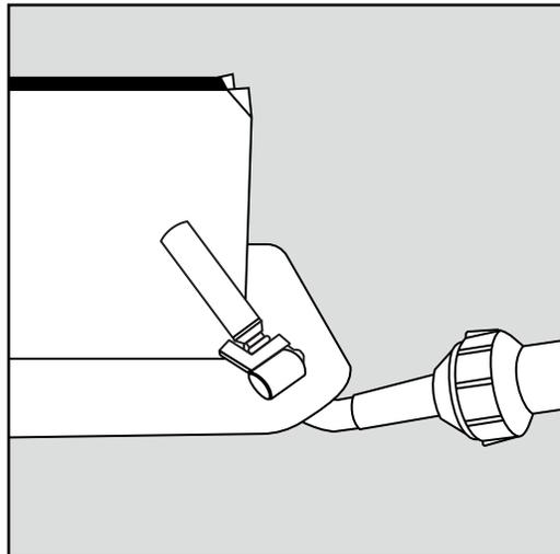
Souder la boîte d'étanchéité à la membrane à l'aide d'un pistolet thermique de soudage. Veuillez consulter les instructions de votre fabricant avant de procéder avec cette étape.
