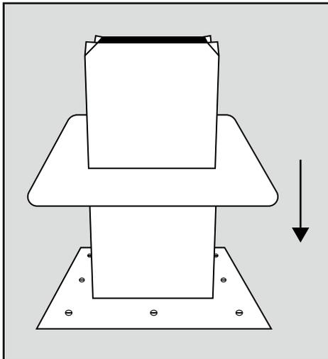
Poser la boîte d'étanchéité sur la base du ventilateur en la glissant vers le bas.
