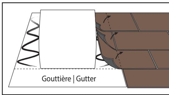
Glisser le solin sous les bardeaux de côté et du haut et le visser sur le pontage de la toiture. Soulever les bardeaux du côté et du haut et les coller au solin à l'aide de Ciment Plastique Condor. Attention de ne pas mettre de Ciment Plastique sur la gouttière du solin, partie du bas. Fixer les côtés métalliques du solin de façon à ce qu'il soit de niveau.
