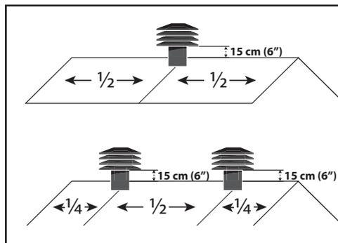
Les ailettes d'un ventilateur Optimum doivent dépasser de 15 cm (6") tout mur, parapet, cheminée avoisinant. Garder une distance minimale de 1,25 m (4 pieds) entre le ventilateur et tous autres obstacles. Le ou les ventilateurs doivent être installés centrés près du faite soit environ 20 cm (8") pour que les ailettes dépassent d'au moins 15 cm (6") le faite du toit.
