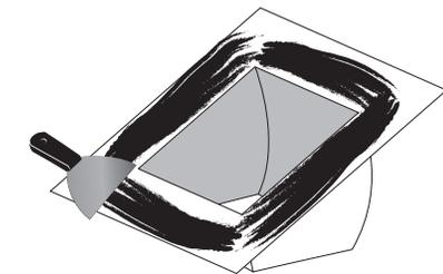
Appliquez généreusement du scellant de calfeutrage type CR20 en-dessous du solin afin de rendre étanche l'espace entre le toit et le ventilateur.
