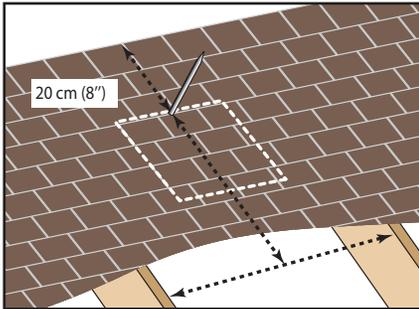
Déterminez la position de l'unité. Localisez dans l'entretait où sont situés les fermes de toit (truss) et positionnez entre les fermes de toit à une distance de 8" ou moins du faite de toit.
