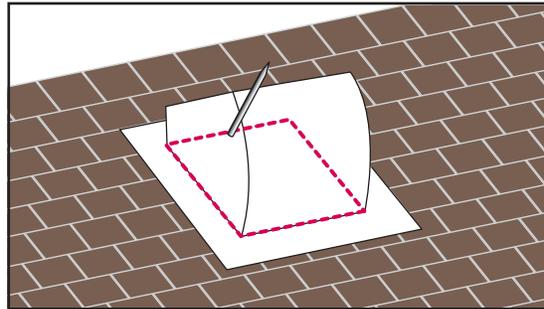
Tracer à l'aide d'une craie l'intérieur du solin avec le clou en plein centre, en s'assurant d'avoir le solin parallèle au faite du toit. Les ailettes du ventilateur doivent dépasser d'au moins 30 cm (6") le faite du toit.
