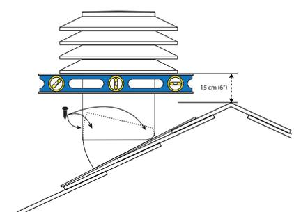
Monter la fixation du solin pour avoir un angle de niveau à 90°. Placer le ventilateur sur le solin. Fixer la tête du ventilateur sur le solin en s'assurant qu'elle soit de niveau et à 15 cm (6") au dessus du faite de toit. Placer une vis dans chaque trou pré-perforé.
