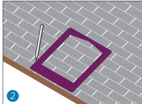
2 Placer le gabarit sur la toiture, centré entre deux poutres.
