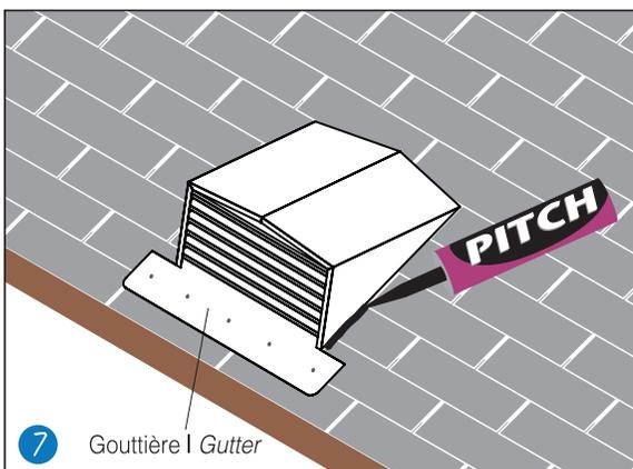
7 Installer à nouveau les bardeaux autour du solin. Fixer la gouttière à l'aide de vis galvanisées avec des rondelles de caoutchouc. Appliquer du ciment plastique au joint tout le tour de l'unité pour assurer l'étanchéité.
