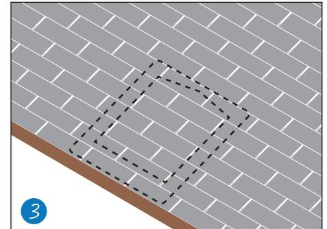
3 Découper les bardeaux avec soin et ensuite découper l'ouverture dans la toiture.
