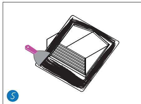
5 Appliquer du ciment plastique CR20 ou T20 sur la surface en dessous du solin et fixer à la toiture à l'aide de vis.
