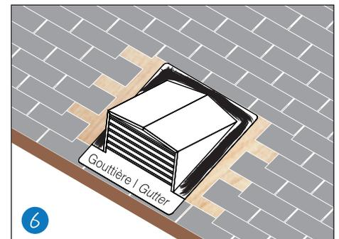
6 Appliquer du ciment plastique CR20 ou T20 sur l'épaulement du dessus du solin. Attention de ne pas mettre de ciment plastique sur la gouttière du solin, partie du bas.
